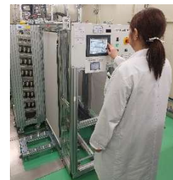
土日対応自動BOD測定装置
