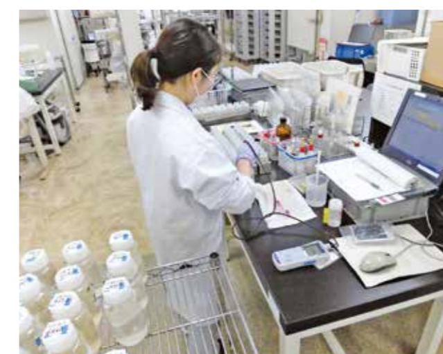
分析室内での浄化槽放流水の水質検査
