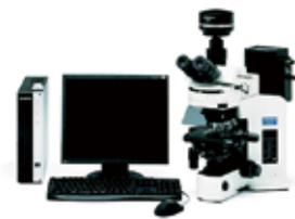
写真の顕微鏡は「微分干渉顕微鏡」といって、生きた微生物を鮮明に観察することができる優れた顕微鏡です。
