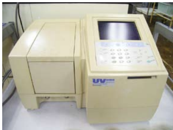
吸光度を測定する分光光度計
