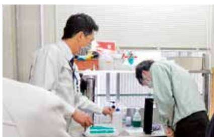
浄化槽放流水の透視度測定
