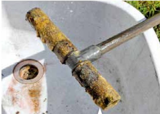
散気管の目詰まり
