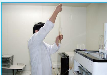
試料の希釈・調整1日目のDOを測定
