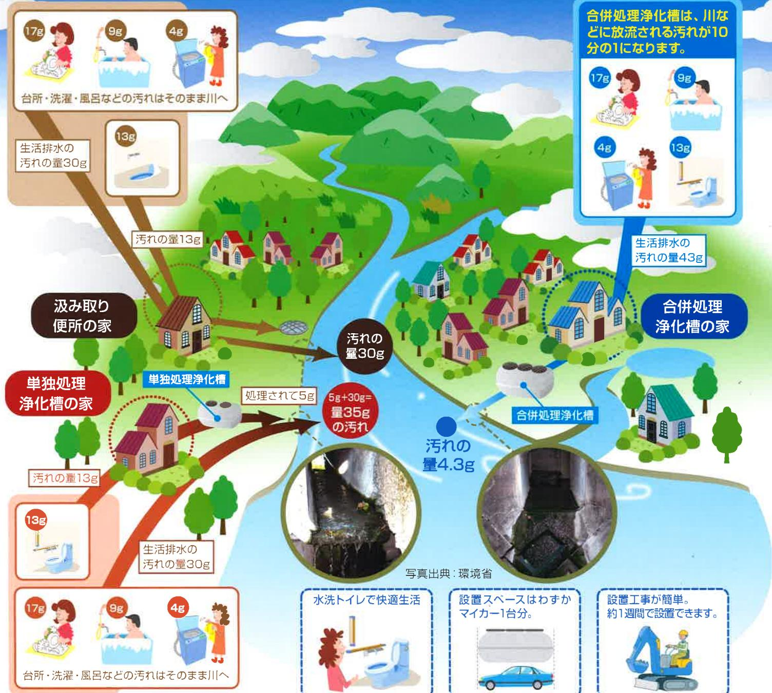
合併処理浄化槽は、川などに放流される汚れが10分の1になります。
