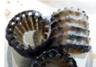
(担体流動槽の担体の肥厚のようす)
