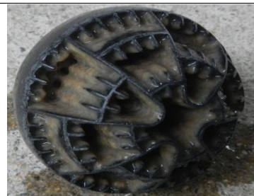
担体流動槽の担体
